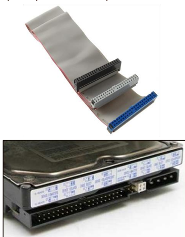
Slika 1-18. Vrste čvrstih diskova i njihovih priključaka (kontrolera). (iz vlastite kolekcije)
