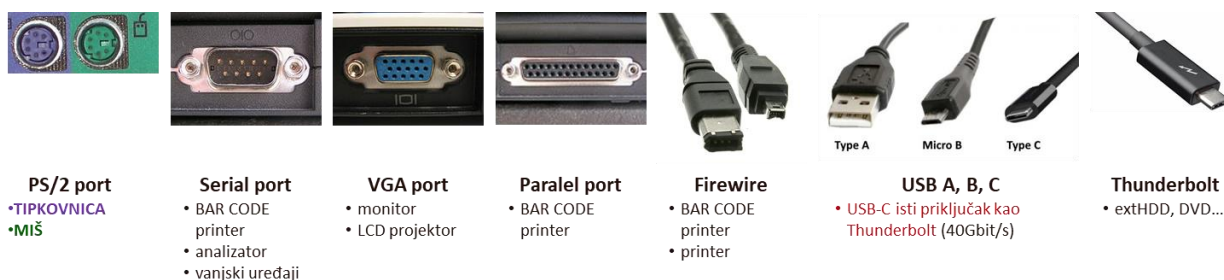
Slika 1-16. Tipovi fizičkih priključaka. Neki su priključci sličnog oblika, ali nisu iste namjene, pa kada pokušavamo priključiti vanjski uređaj treba paziti na njihovu razliku, da se ne oštete konektori. Na primjer, serijski priključak za priključivanje vanjskog analizatora muškog je tipa (ima nožice), dok je VGA priključak za monitor ženskog tipa – ima utore. Firewire, USB i
